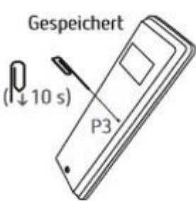
Für den Datentransfer aus der Fernbedienung in die App drücken Sie den Knopf P3 solange bis ein Dauerton erklingt. Wenn das der Fall ist drücken Sie die oberste Taste der Fernbedienung. Der Ton ist aus. Sobald der Ton wieder beginnt drücken Sie auf die Taste Open im Fenster Lamellen.
