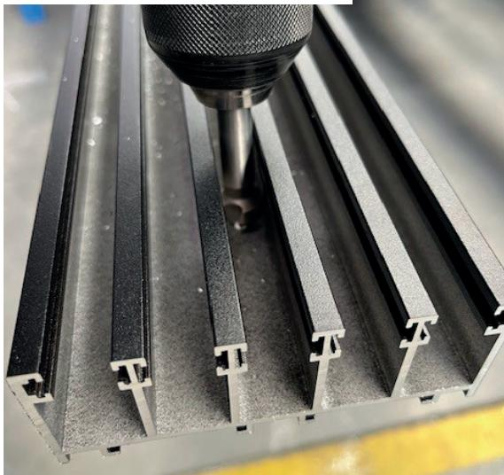
Wenn ein INVIGO PRO unter der Dachrinne platziert wird, muss es zuerst mit einem Ø4,2-mm-Bohrer vorgebohrt werden. Wiederholen Sie dies alle Meter und senken Sie die Löcher ab.
