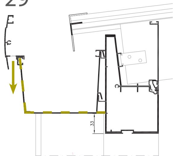
Den Rand zwischen dem Rinnenkasten und dem hinteren Teil der Rinne einkitten. Für den Überlauf Löcher mit 1000 mm Achsmaß bohren.
