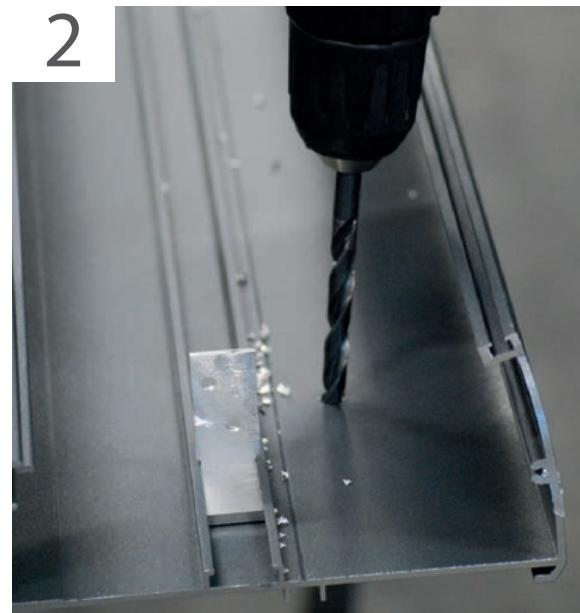
Die Erhöhungsstücke aus dem Mauerprofil ausrasten lassen, indem man sie auf sich zu zieht. Den halben Bügel in einem Abstand von 55 mm von der Seite des Mauerprofils montieren.
